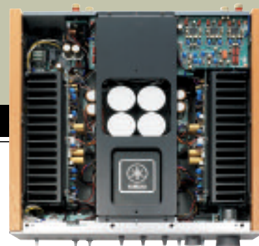
W pełni symetryczna konstrukcja rozdzielająca prawy i lewy stopień.
